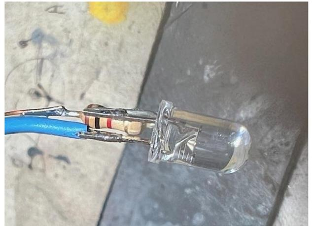
Souder la résistance au plus proche sur une patte de la LED et le fil fin laiton sur l'autre patte de la résistance puis souder le fil gainé épais, bleu ici, sur la deuxième patte de la LED. Peu importe le sens de la résistance ou de la LED : c'est l'arrivée du courant qui déterminera l'allumage de la LED (si la LED ne s'allume pas, il suffit d'inverser la polarité).
