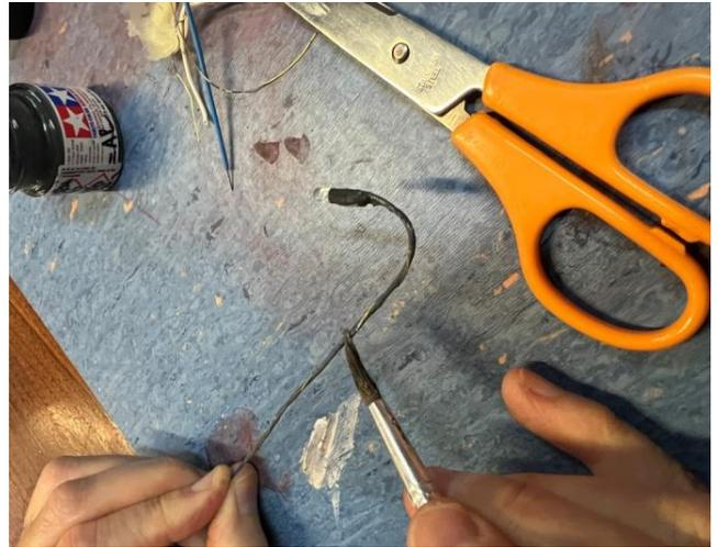
Les mats sont constitués du fil bleu et du fil de laiton qui sont collés l'un sur l'autre. Il est possible de les entourer avec de la gaine rétractable ou de les passer dans une paille en coton-papier. La dernière étape est la peinture.
