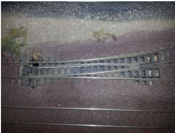
Aiguille peco avec la pointe de cœur isolée
