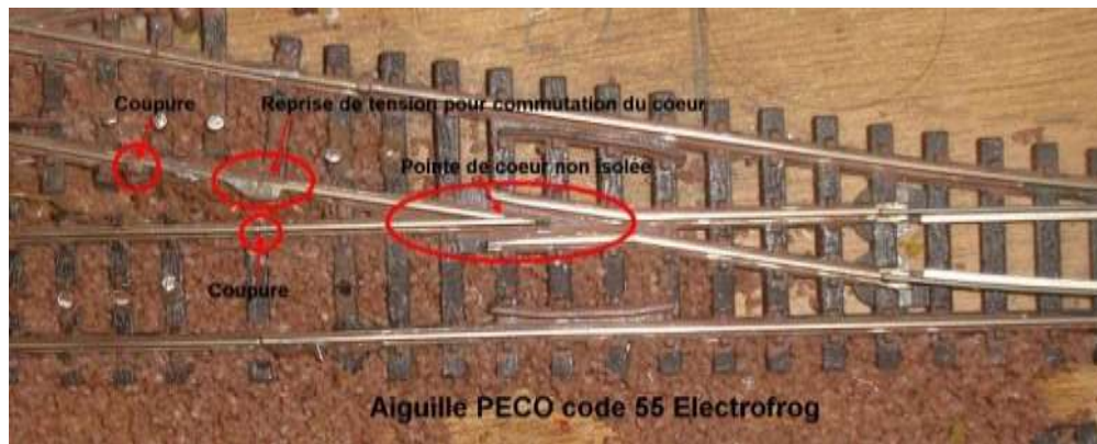
Aiguille peco avec pointe de cœur non-isolée
