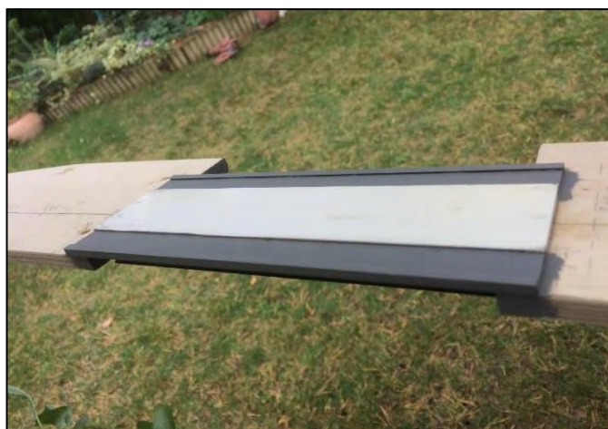
Tablier de pont (béton/poutrelles) vu de dessus et de dessous (en noir les poutrelles en I)
