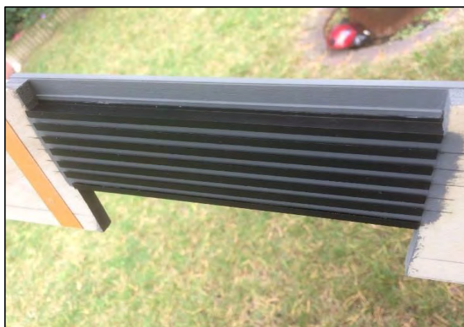
Tablier de pont (béton/poutrelles) vu de dessus et de dessous (en noir les poutrelles en I)
