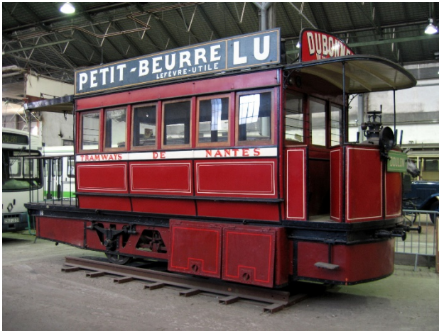
Tramway air comprimé motrice Mékarski n°22 Nantes 1879
