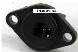
Embases et connecteurs DIN 41529 utilisées pour la connectique de liaison entre modules
